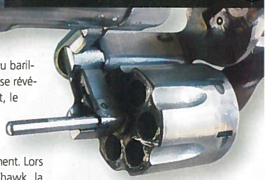
L'avant du support de barillet vient s'ancrer sur la carcasse par le biais d'un verrou.
