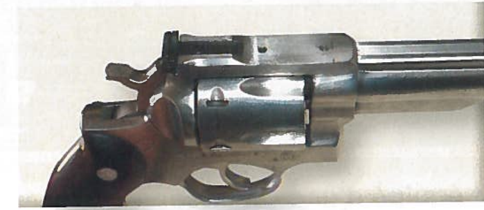
La hausse est largement encastrée dans la carcasse ; à noter les deux taraudages prévus pour la fixation d'une lunette.
