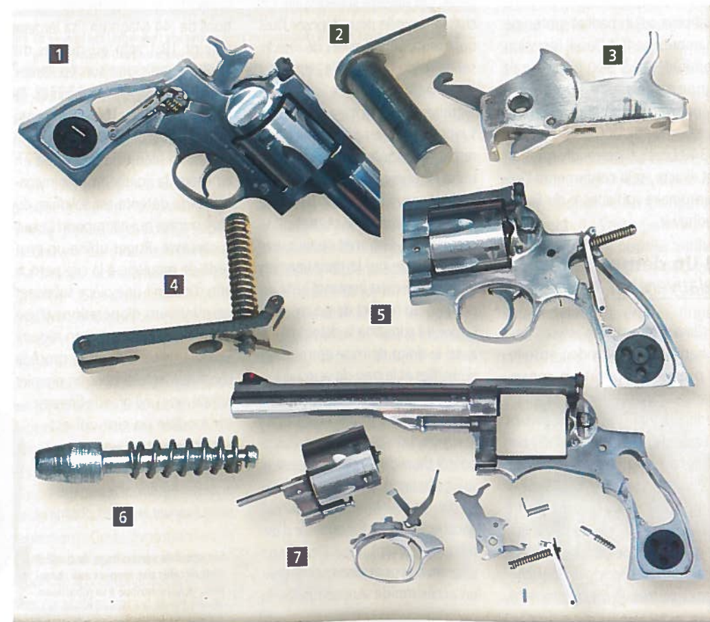
1 - Démontage du Redhawk, la première opération consiste à armer le chien et bloquer son ressort avec une pige. 2 - Seconde opération : déposer l'axe supportant le chien. 3 - Troisième opération : déposer le chien, réalisé en moulage à la cire perdue. 4 - Quatrième opération : déposer le ressort de percussion et son support. 5 - Cinquième opération s'aider du support de ressort pour tirer sur le verrou du pontet et déposer ce dernier. 6 - Le verrou du pontet est extrait par l'avant de la carcasse. 7 - Une fois le pontet enlevé, l'ensemble barillet est facile à retirer de la carcasse.
