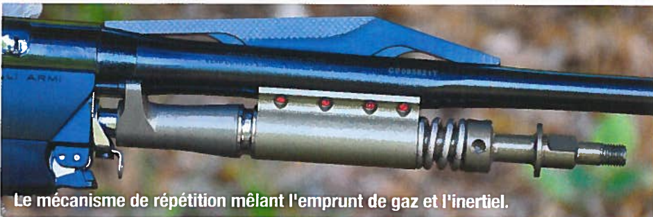
La tête de culasse intègre l'extracteur à griffe et l'éjecteur sous tension de ressort.
