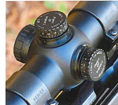
Le réglage de la lunette est aisément accessible. La valeur d'un clic représente 15 mm à la distance de 100 mètres.
