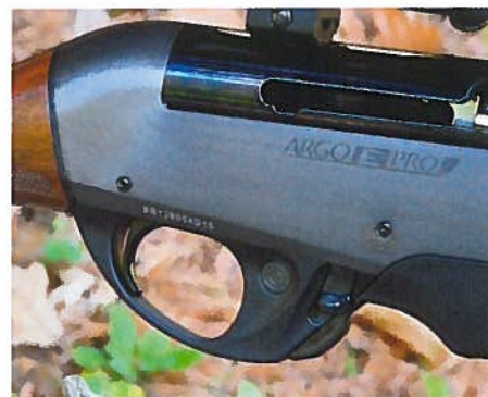
La sous-garde avec les poussoirs d'ouverture du chargeur (par basculement) et le libérateur de la culasse.
