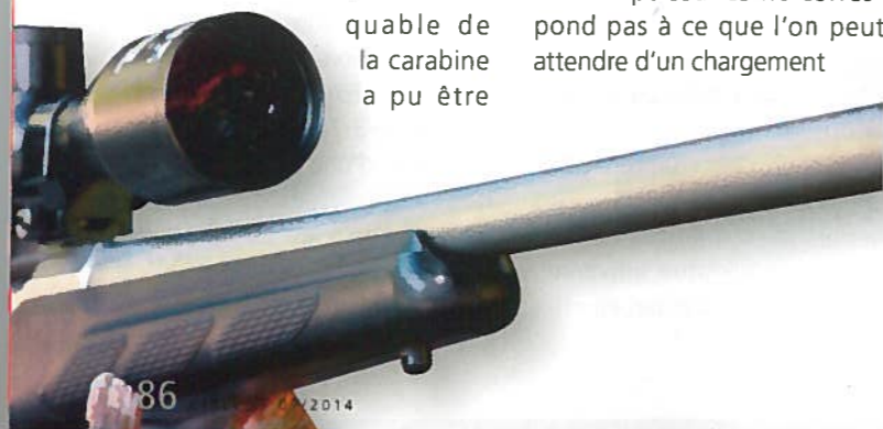
La position armée est détectable à la vue et au toucher, grâce à la prolongation du percuteur qui fait saillie à l'arrière du bouchon de culasse.
