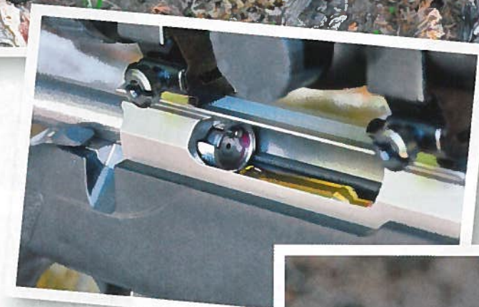
Lorsque la culasse est ouverte, on voit la cuvette de tir avec la griffe d'extraction et l'éjecteur sous tension.
