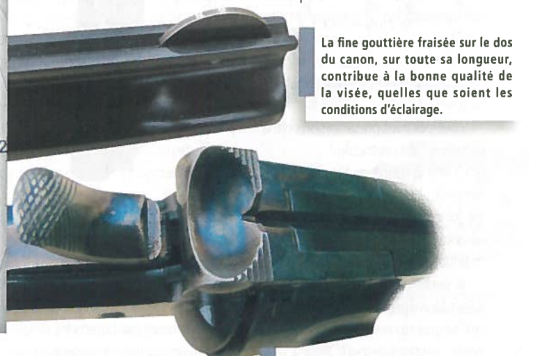
La large partie haute du segment arrière du verrou de canon est nettement concave. À son sommet, elle porte le cran de mire en "U" bien appareillé au guidon.
