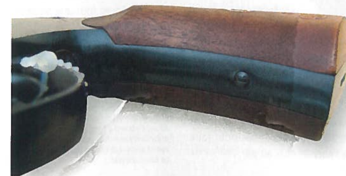
Une petite vis entrant par l'avant du cadre de poignée permet d'agir sur la tension du grand ressort de chien.
