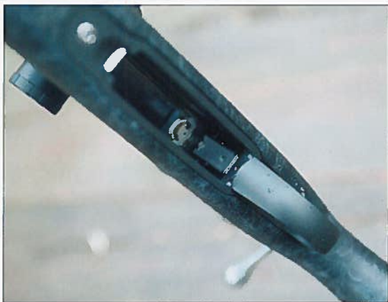
En ôtant le chargeur, on découvre la face avant du squelette d'aluminium au dessus du pontet.
