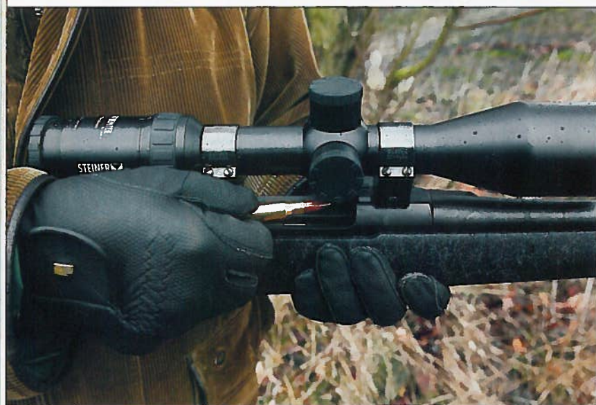
Le chargeur peut être garni une fois démonté ou depuis la fenêtre d'éjection.
