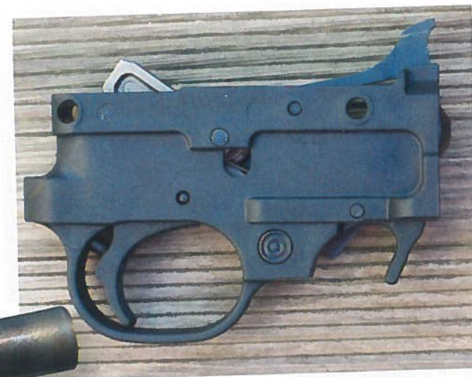
Ci-dessus : le bloc détente est facilement démontable pour un nettoyage complet. C'est qu'avec sa cadence de tir, la 10/22 est une grande gourmande et que fatalement elle se tache ! Un petit nettoyage du bloc détente de temps à autre ne fait jamais de mal. À gauche : le verrou du système Takedown fixé sous le canon.
