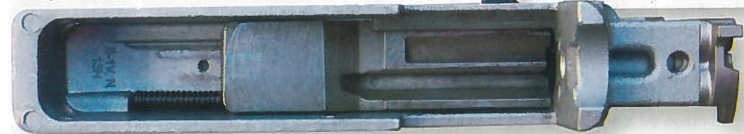
Ci-dessus : la masse mobile en position fermée. Elle contient le percuteur et l'extracteur. Elle est le cœur du système Ruger 10/22. À gauche : même rabattue vers l'avant, la hausse peut empêcher le démontage avec la lunette en place si les colliers sont trop bas comme ici ces superbes TPS. Ci-dessous : pas moins de 32 mm de canon viennent s'emmancher dans l'insert acier du boîtier. Notez, sur la partie droite, la came du verrou de blocage en excroissance.
