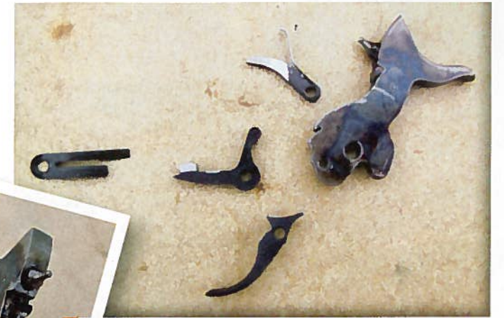
Ci-dessus, comme le montre cet éclaté de la platine du Remington 1875, la mécanique est presque identique à celle des bons vieux New Model à percussion. Mais le chien possède trois crans creusés à l'avant de sa partie inférieure : sûreté, demi-armé et armé complet. À gauche, en enfonceant la lame d'un petit tournevis droit au fond du cran de sûreté, on pousse vers le haut le petit axe logé dans le corps du chien. Ceci a pour effet de faire basculer la cale vers l'avant. Dès lors, le chien ne vient plus à l'abattu complet.
