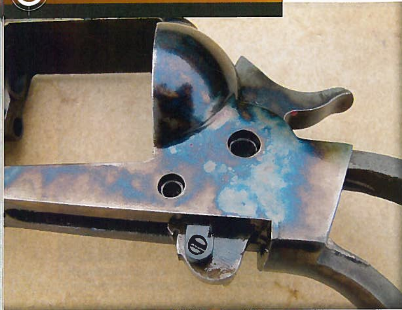
Le doigt élévateur est vissé sur la gauche du chien, exactement comme sur les revolvers Remington des générations précédentes.
