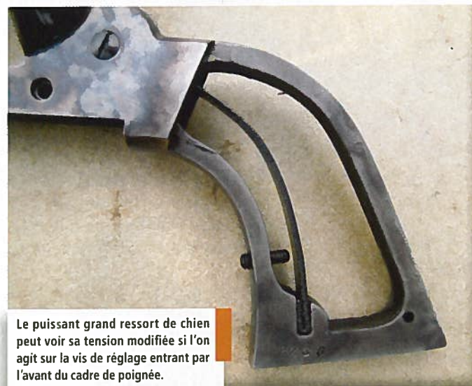
Le doigt élévateur est vissé sur la gauche du chien, exactement comme sur les revolvers Remington des générations précédentes.
