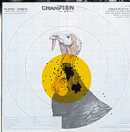
Cible réalisée à la distance de 9 m avec une cartouche Federal Premium 3RD Degree de 35,44 g en calibre 12/76 mm tirée dans un canon de 61 cm
