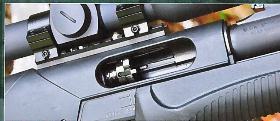
Gros plan sur la fenêtre d'alimentation de la chambre. On distingue la tête de culasse à verrouillage rotatif et la butée d'éjection opposée à la griffe d'extraction.
