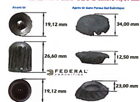
Décomposition de phases de la balle Federal de calibre 10 type Foster avant tir et après tir.
