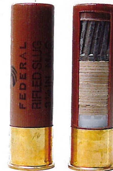
Vue en coupe d'une cartouche à balle de calibre 10/89 mm.
