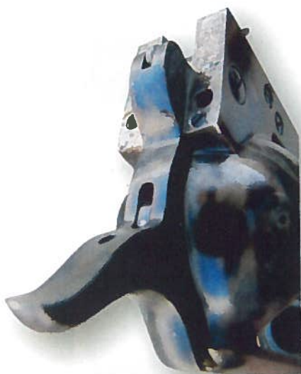
La petite vis entrant à l'arrière de la carcasse, à gauche du chien, au-dessus de la vis servant à relier carcasse et cadre de poignée, débouche sur un petit canal débouchant à l'arrière du doigt élévateur.
