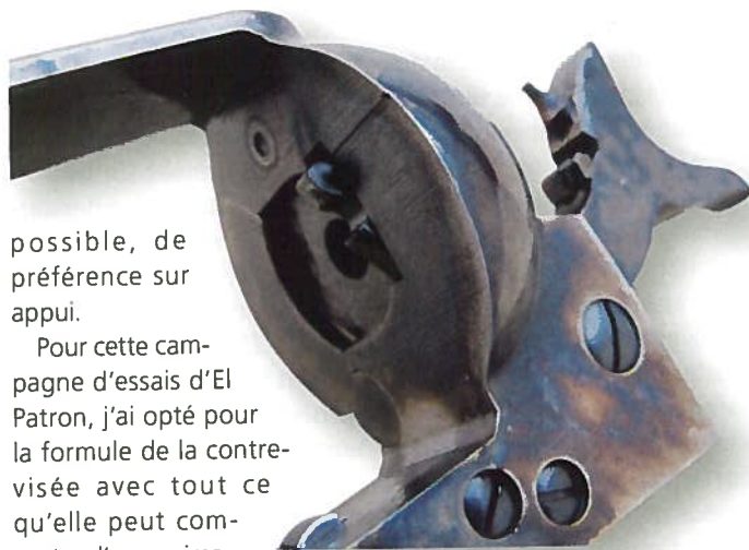
L'efficacité du doigt élévateur du barillet est parfaite en toutes circonstances.
