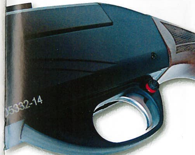
Le bouton de sécurité est placé sur l'arrière du pontet ; il a une action transversale qui empêche tout départ accidentel.
