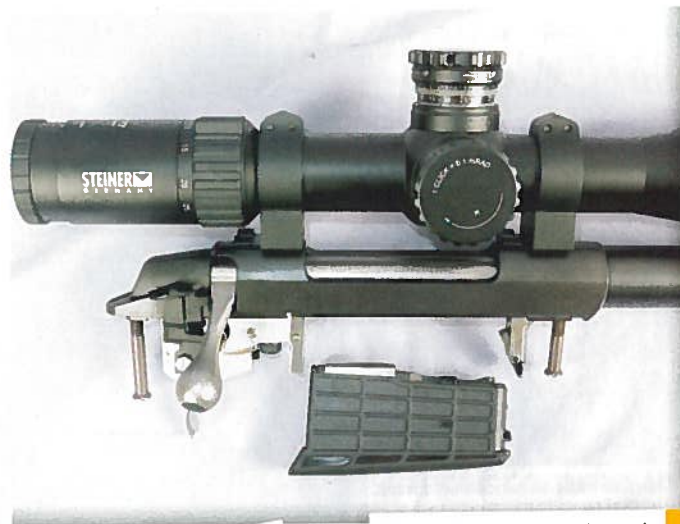
Action démontée, on voit que le bloc détente est du solide. Notez les lèvres en acier inox du chargeur qui se remplit également par le haut en passant par la fenêtre d'éjection.
