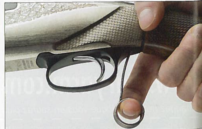
Avec cette petite clé que l'on actionne du bout de l'index, on dépose aisément le mécanisme de percussion.
