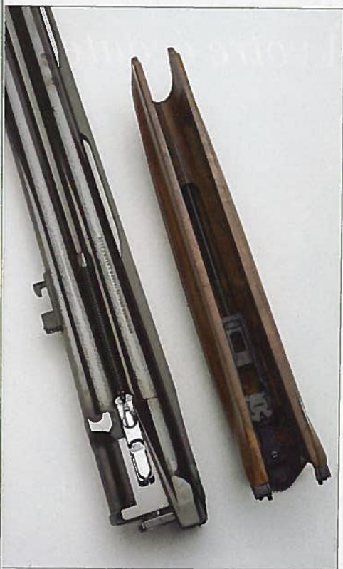
Les éjecteurs sont uniques en leur genre. Ils s'arment au tir. À la percussion, un guide du ressort vient prendre place dans les tire-cartouches. Benelli parle d'éjecteurs à impulsion.
