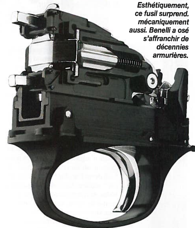
La mécanique déposée dévoile une batterie en ligne à la façon de celle du Blaser F3 ou du Fias.
